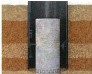
1.杭芯に設置した全周回転機により、ケーシングを計画深度まで回転圧入する。
