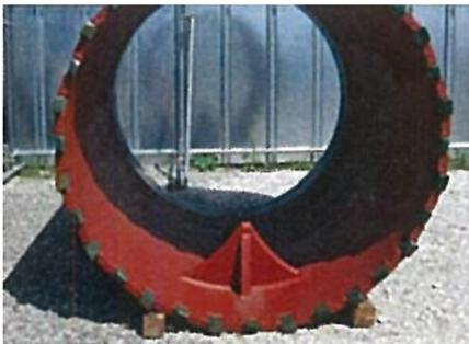
杭径がΦ1,000mm、Φ1,200mmにおいては、油圧ユニットを伴わない水平切断刃が固定式のタイプがある。
