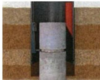
3.同時にケーシングを引き上げながら、杭体の主筋を切断する。
