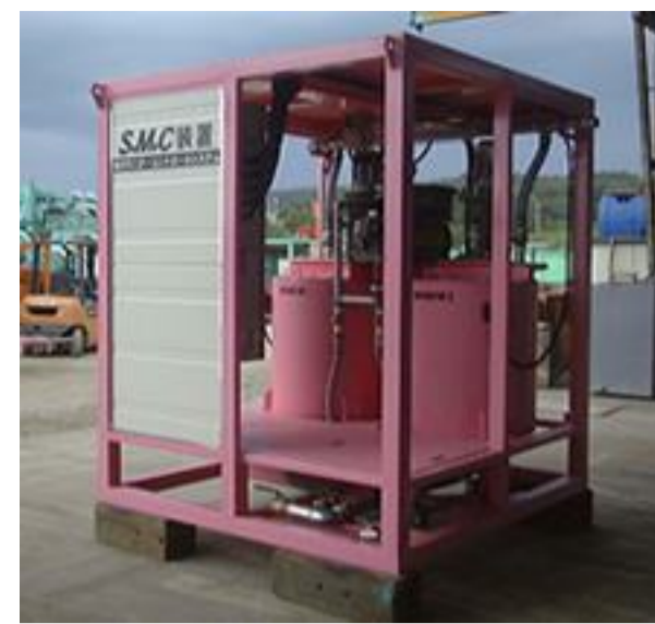
自動滑材注入装置(SMCプラント)
